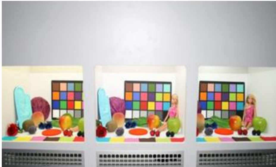
Abbildung 4.13: Probandenversuch zur semantischen Deutung der Farbunterschiede Durch weiße LED-Lichtquellen beleuchtete Körperfarben. Die Probanden interpretierten die Farbunterschiede zwischen den unterschiedlich belichteten Kammern
