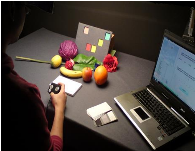
Abbildung 4.22: Probandenversuches zur akzeptanzbezogenen Skalierung der Farbwiedergabe
