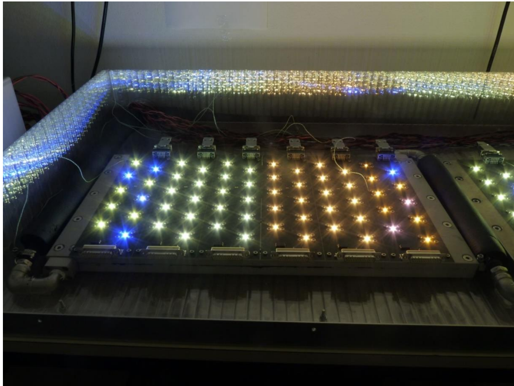
Abbildung 2.9: Veränderungen nach ca. 9000 h Betrieb bei 95 °C Umgebungstemperatur
