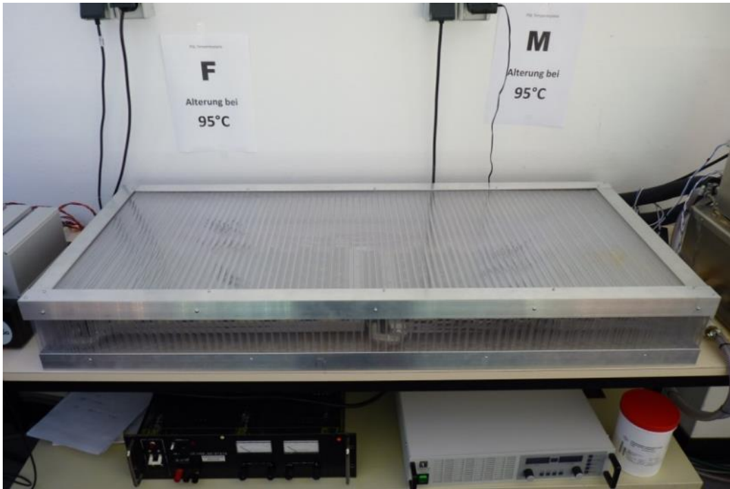
Abbildung 2.7: Geschlossenes Case umfasst 2 Platten mit insgesamt 12 Platinen, 120 Prüflingen
