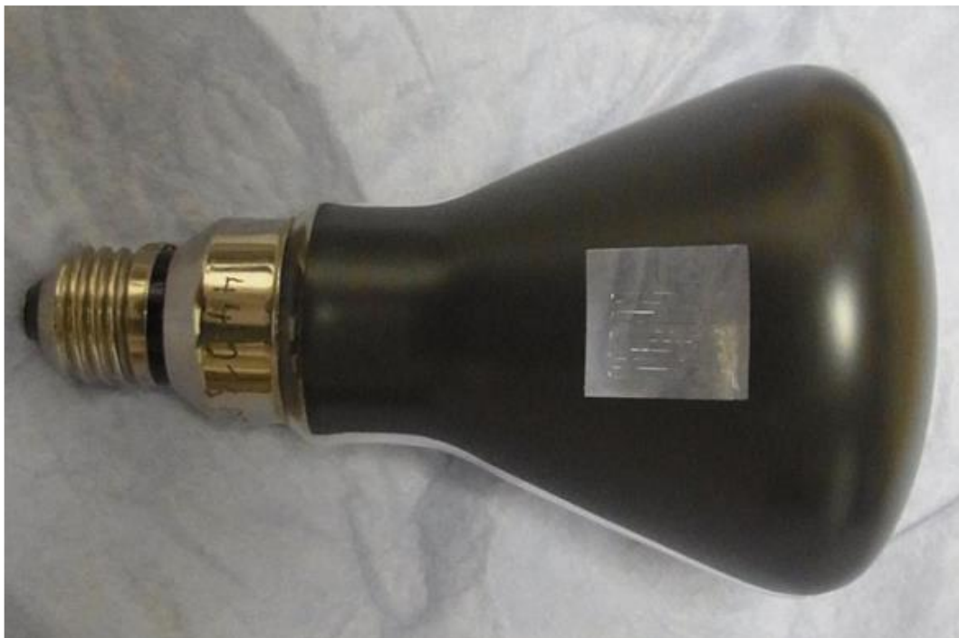
Abbildung 6.5: Lichtstärkenormallampe Wi41-G zur Kalibrierung des Drehspiegelgoniophotometers
